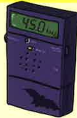
ばつていテクター コウモリ類の超音波をヒトが聞こえる音に変える。
